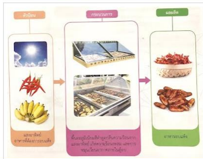
รูป 3.7 แผนภาพระบบทางเทคโนโลยีของตู้อบพลังงานแสงอาทิตย์
