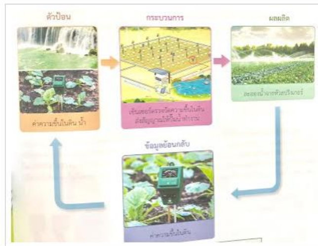
รูป 3.7 แผนภาพระบบทางเทคโนโลยีของการรดน้ำอัตโนมัติแบบวัดความชื้นของดิน
