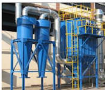
รูป ไซโคลนในโรงงานอุตสาหกรรมและระบบทำงานภายใน
